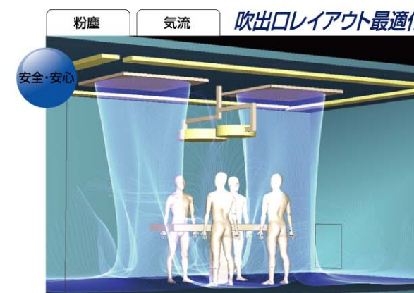
医療施設 吹出口レイアウト最適化 温度・気流分布の他に、清浄度についても事前に検討できます。
