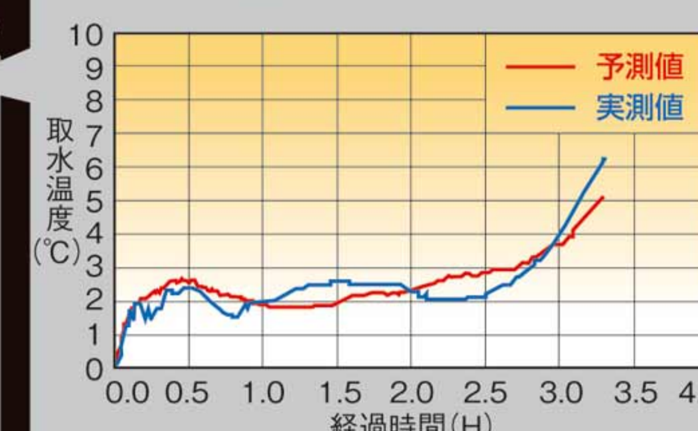
■蓄熱槽取り出し冷水の温度変化
