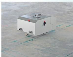
業務のロボット化(墨出し作業の自動化)
