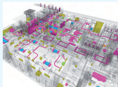
BIMによる資機材の発注管理 (緑は発注済、ピンクは未発注)
