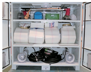
コンパクトな排水ポンプパッケージ
