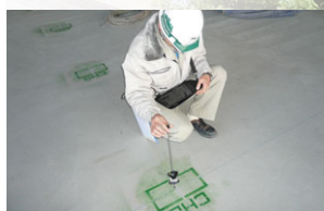
専用プリズムでレーザー照射を捕捉
