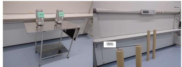
図 3 モニタリングの様子(左:浮遊菌、右:落下菌)
