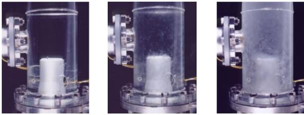
①過冷却水が流入 ②氷核発生装置作動 ③連続製氷状態へ移行
