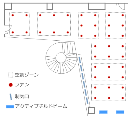
図-3 制気口の配置状況
