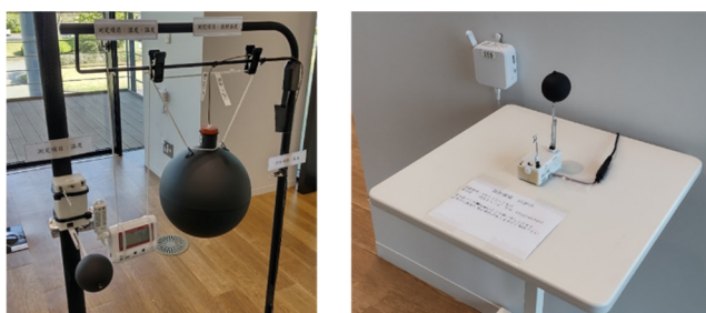
図-4 ①点の計測用ポールと小型PMV計 (左) A点無線式多機能センサーと小型PMV計 (右)
